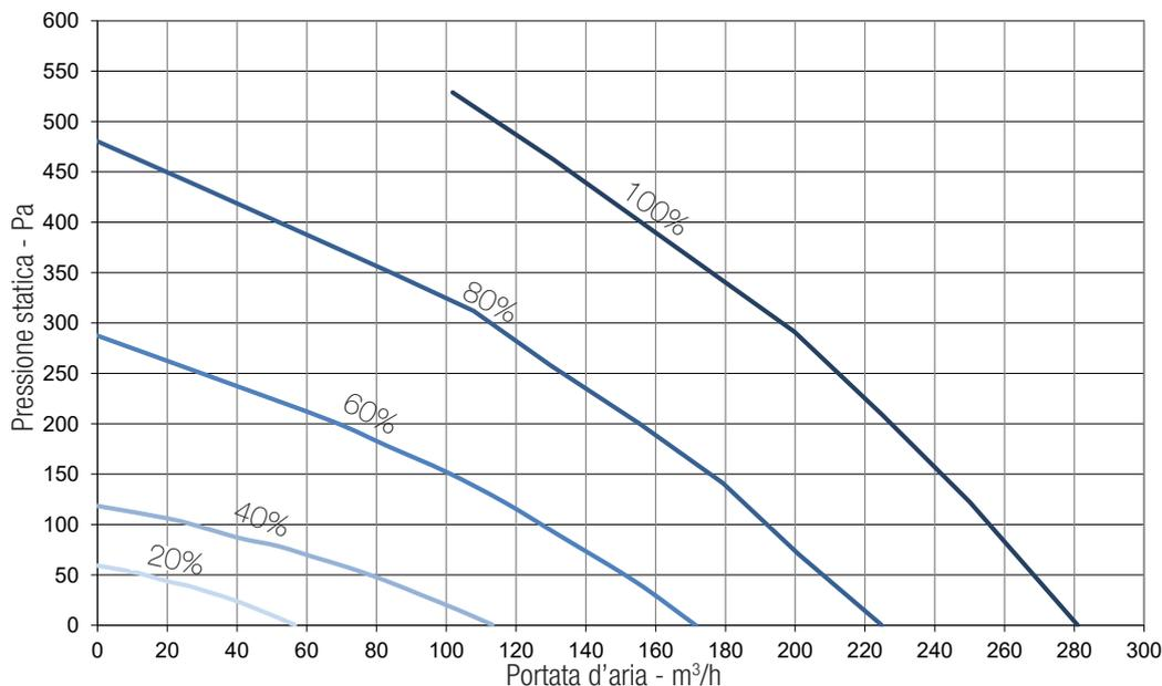
Fig. 6.a Curva di immissione in accordo al Reg. 1253/2014 (ErP).
